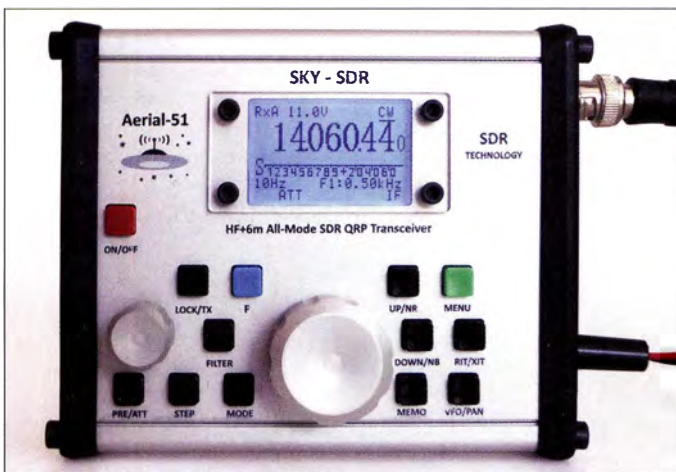
Bild 1: Front-/Oberseite des Sky-SDR mit den Bedienelementen und dem LC-Display Fotos: DK3RED
