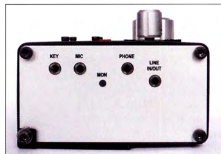
Bild 4: Linke Seite des Sky-SDR mit den 3,5-mm-Klinkenbuchsen für Morsetaste, Mikrophon, Kopfhörer und Line-In/Out; die Lautstärke des Mithörtons lässt sich nur über einen Steller hinter MON ändern.
