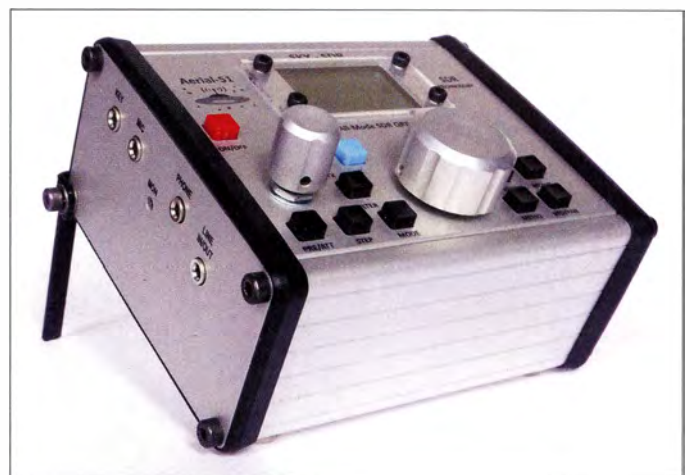
Bild 1: Front-/Oberseite des Sky-SDR mit den Bedienelementen und dem LC-Display Fotos: DK3RED
