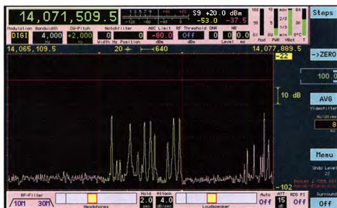
Wer die schnelle Spektrumanzeige schätzt, hat auch diese Möglichkeit – hier gezeigt im PSK31-Bereich des 20-m-Bandes.
