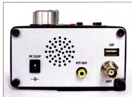
Bild 5: Rechte Seite des Geräts mit den Buchsen für die Spannungsversorgung, den PTT-Ausgang, die CAT-Schnittstelle und die Antenne
